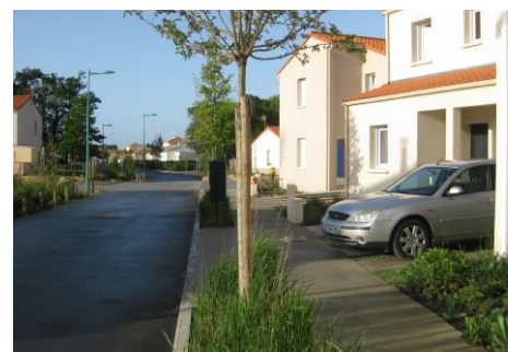
Exemple de voie structurante avec emprise piétonne proposant un traitement paysager sobre et économe
